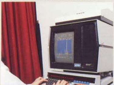
X線微小解析(XMA) 電子ビームにより試料から出てくるX線で定性解析、分散性などチェック。
