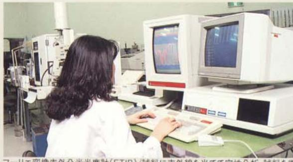
フーリエ変換赤外分光光度計(FTIR) 試料に赤外線を当てて定性分析、試料を微細に測定。
