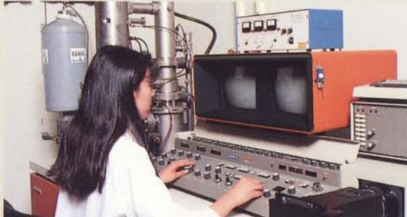
走査電子顕微鏡(SEM) 電子ビームを試料の表面に当てて何万倍もの倍率で微細な現象を測定。
