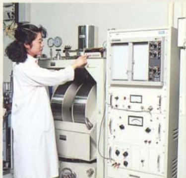
振動試料型磁力計(VSM) 試料に特殊な振動を加えて磁気特性を精密に測定。
